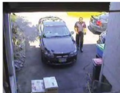
Режим WDR включен. Объекты видны отчетливо.
